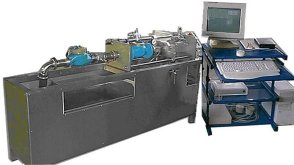
*Geeignet zum Justieren und Prüfen von Wasserzählern in den Bereichen Produktion, Service und Reparatur*
